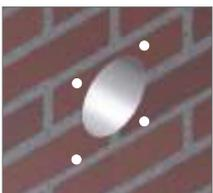
Com a furadeira faça os furos para colocar as buchas (vendidas separadamente). Depois, com o auxílio de uma serra copo ou outra ferramenta, faça a abertura na parede.
